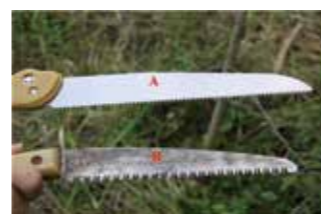
A鋸齒較細，B鋸齒較大，5公分以內小枝條使用細鋸齒能使傷口較平滑，傷口較容易癒合
