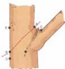
闊葉樹不得已要截幹時，正確之位置為A、B，其中F為枝皮脊線之端部，B和F在同一水平上；不正確之位置AE、AD、CE、CB和CD。
