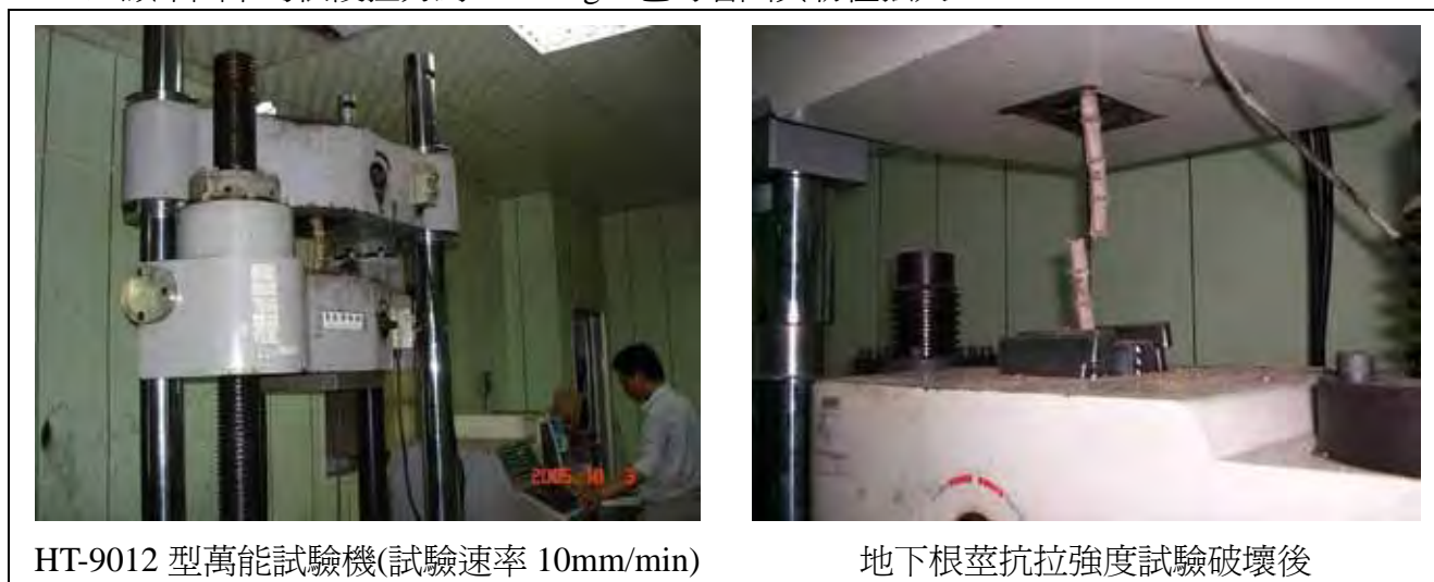
圖 3. 實驗室單根拉拔試驗
