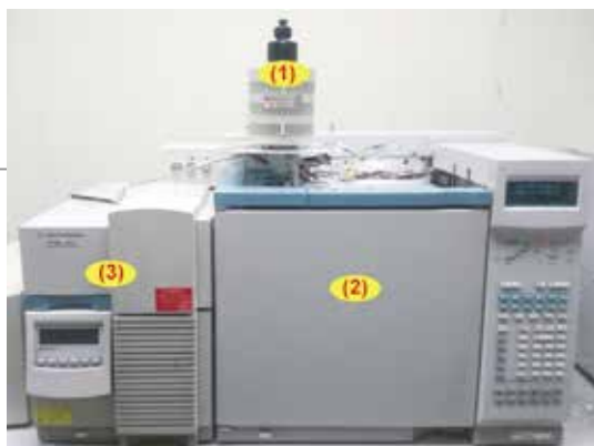
熱裂解氣相層析質譜儀組成圖：(1)為熱裂解儀、(2)為氣相層析儀、(3)為質譜儀。(徐光平 攝)
