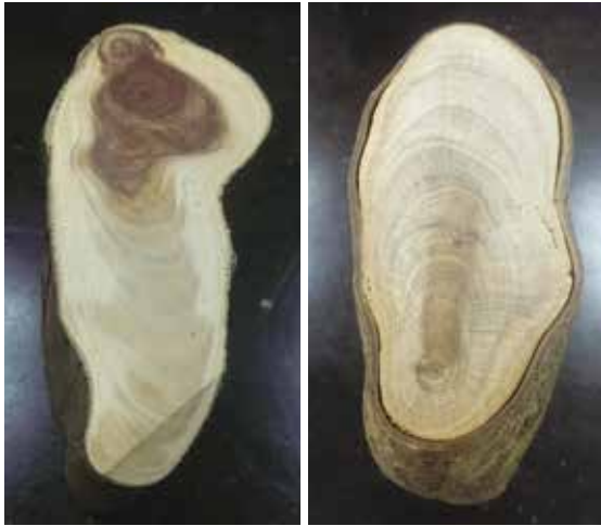
左圖：被壓材(龍柏)；右圖：引張材(桃花心木)。(林振榮 攝)
