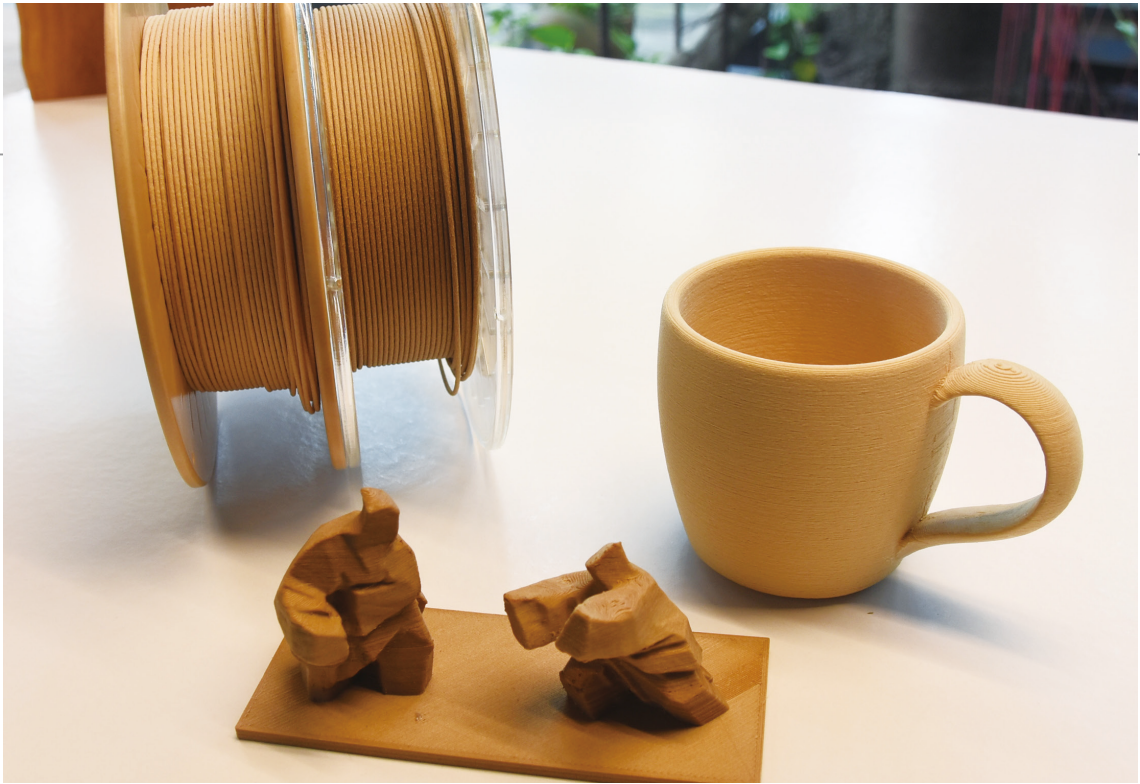
將木質廢棄物加工成木粉與PLA材料混練變成3D列印機使用的PLA/木粉纖維環保線材，可以賦予成品有木頭的質感。
