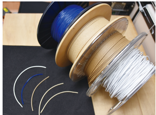
3D列印使用的列印線材可以有各種不同的材質。
