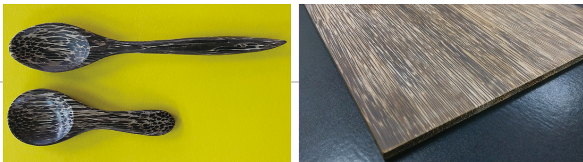
圖5 (左)以射葉椰子為材料製作而成的湯匙，紋理甚美。(陳正豐 攝)；(右)射葉椰子製成的集成板具有特殊紋理，可應用於拼花地板及家具上。(塗三賢 攝)
