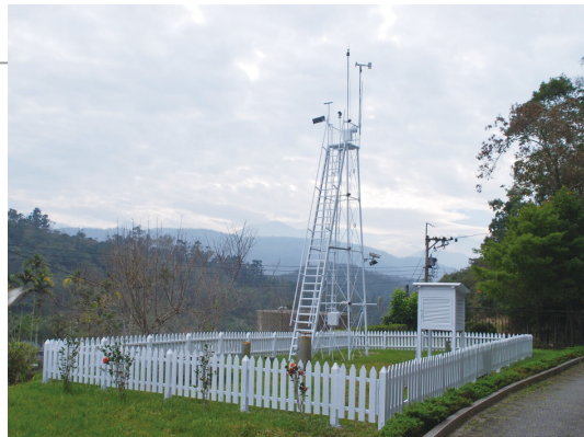
氣象站是集雨量、溫溼度、日照輻射、風速風向等監測儀器所組成。(陸象豫 攝)
