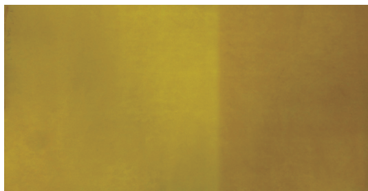
傳統利用黃柏染色(左)，光堅牢度差，只要有光照就容易變色(右)。(徐健國攝)
