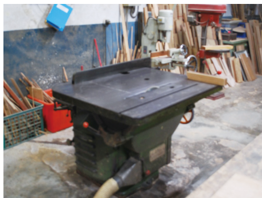
電動桌鋸為現代木工最常使用的工具，木工與裝潢師傅常以電動鋸及木心板自行組裝而成。(陸象豫 攝)
