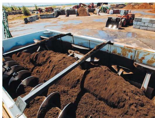
Rexius利用政府補助計畫所建置的土壤添加生物炭混合機。(圖片來源/Rexius)
