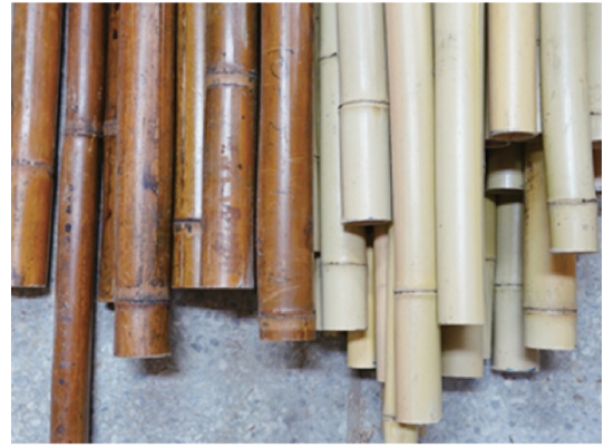
高溫乾燥(左)及氣乾處理(右)桂竹桿材。(李志璇 攝)
