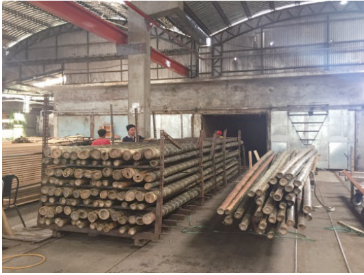
竹桿材高溫乾燥處理進窯作業。(李志璇 攝)
