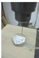
圖 12. 圖案外框上鑽孔 圖 13. 鋸條穿越孔洞 圖 14. 線鋸鋸切情形
