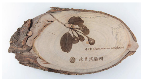
圖 23. 斜切雷雕機刻製勵志格言或圖案圓盤
