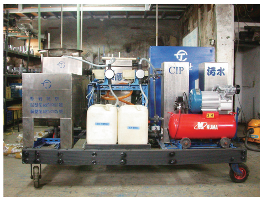
紙業廢水以脈衝電凝先驅廠設備處理效果良好。
