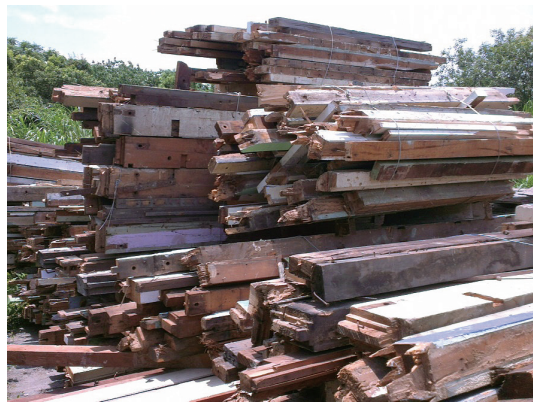
建物拆除回收的木構件舊料。
