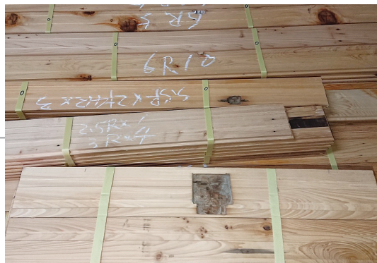
舊門窗斗料加工處理製成的地板及壁板材料。
