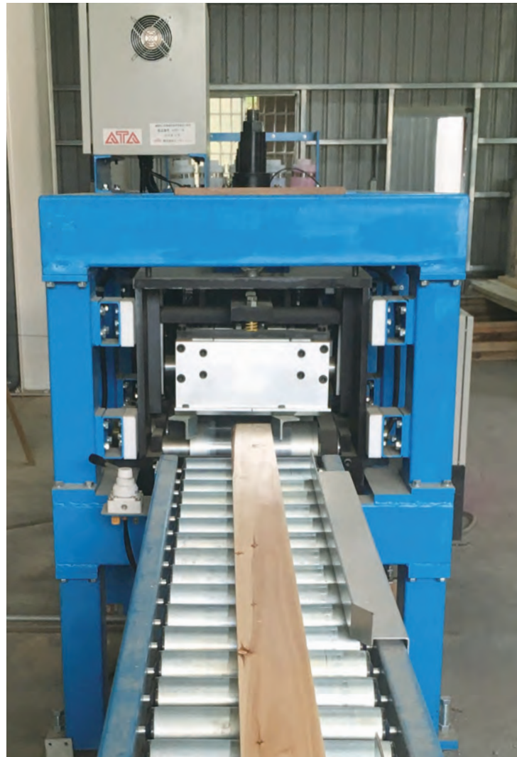
圖3 國立臺灣大學生物資源暨農學院實驗林管理處木材利用實習工廠連續式機械等級區分機參數設定及應力感測控制單元。(林志憲 攝)
