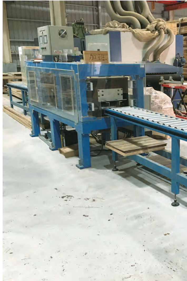
圖2 國立臺灣大學生物資源暨農學院實驗林管理處木材利用實習工廠連續式機械等級區分機。(林志憲 攝)
