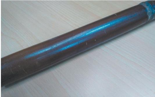
圖4 熱處理桂竹管材後表面顏色褐化 (林柏亨 攝)
