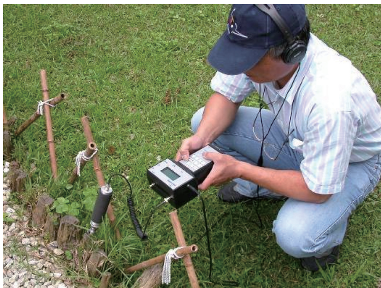
圖3 音波偵測儀可以應用於土壤白蟻檢測(陳克恭 攝)
