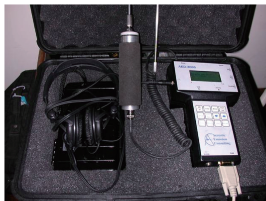
圖2 藉由音波白蟻偵測儀外接錄音設備錄製白蟻活動的音頻，可以對比並判讀白蟻種類(蔡君瑋 攝)
