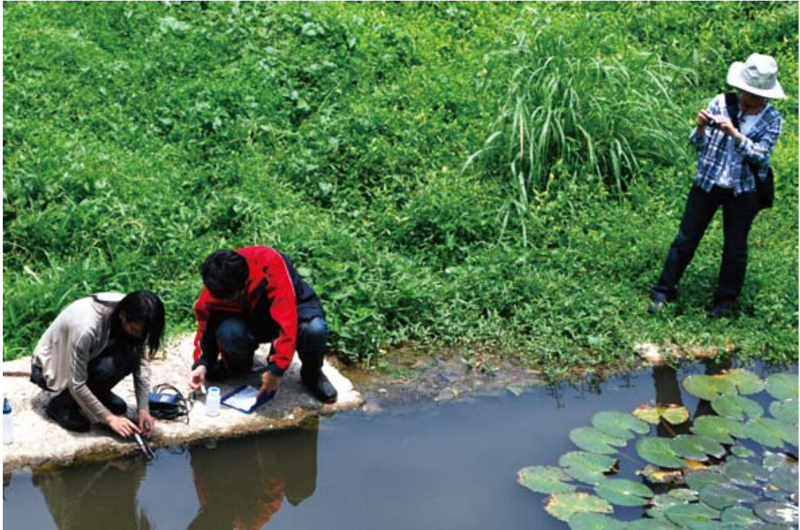
PH值、溶氧量、水溫等因子可在取樣點直接量測(陸象豫 攝)
