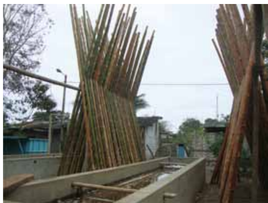
圖1 竹材浸硼砂處理後先曬太陽及陰乾(賴進益 攝)
