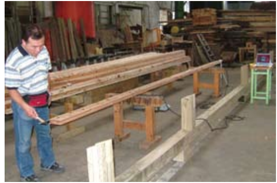
圖4. 棋型樑非破壞性打音振動檢測(李銘鐘 攝)
