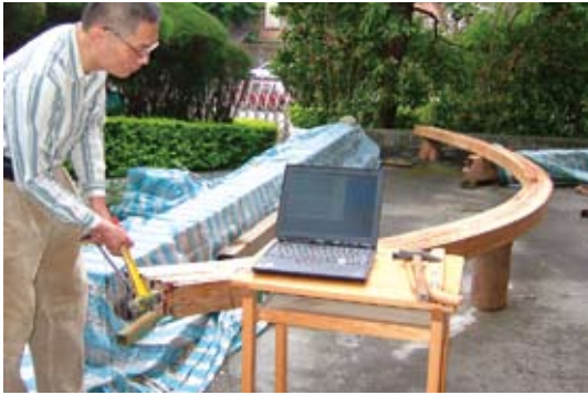
圖3. 板材進行非破壞性打音振動檢測(李銘鐘 攝)
