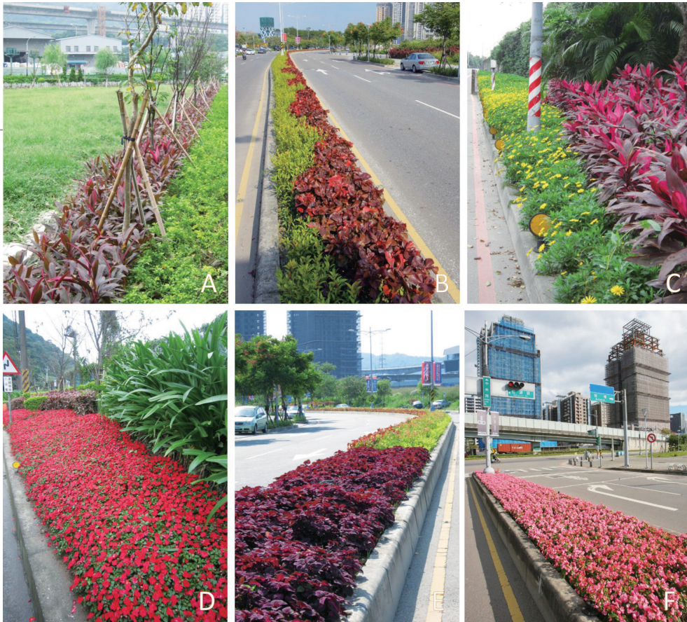
圖4 綠美化工程常用的植栽及配置，透過顏色對比及生長特性營造不同高層與空間感(A-C)；中央分隔道的島頭(最先端)是車輛停滯時間最長的區域，為行車安全不能遮擋視線，常用富有顏色的四季草花來作設計(D-E)。
