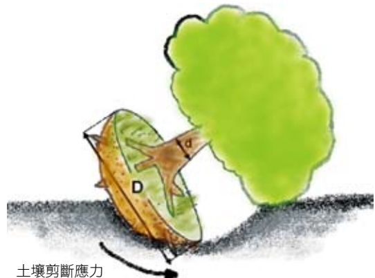
圖9 根盤直徑不足成為樹木抗風強度之瓶頸，颶風來襲時常發生樹木根拔倒伏的現象(許富蘭 製圖)
