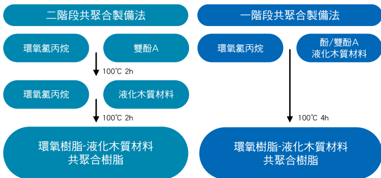
圖7 環氧樹脂-液化木質材料共聚合樹脂之合成方法示意圖
