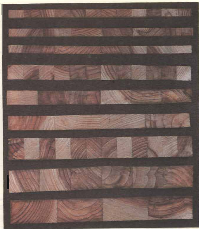
照片1 生材膠合後經人工乾燥之板材橫斷面呈波浪形
