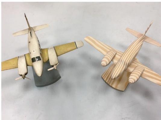
CNC加工完成後的PA-31航測機重製模型(右)與原來的模型(左)
