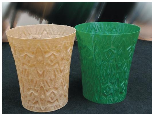
3D列印用的線材除了色料外也可以加入其他材料，賦予成品不同的面貌，左邊的杯子是由加入木粉材料的PLA線材所印出
