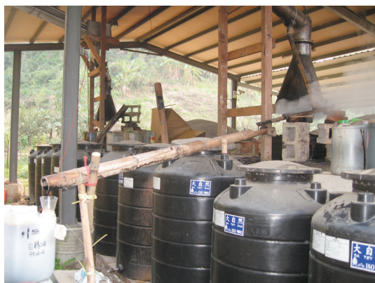
光蠟樹枝梢材製炭過程中，於煙囪溫度80-150°C時收集木醋液。
