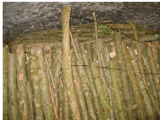
光蠟樹枝梢材進窯時須直立緊密排列，上層橫置之引火材亦須堆放緊密，窯內多處設置K型熱電偶測溫棒，藉以瞭解炭化溫度之上升情形。
