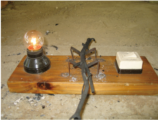
光蠟樹枝梢材於窯內經700°C以上炭化後，具有良好之導電性。
