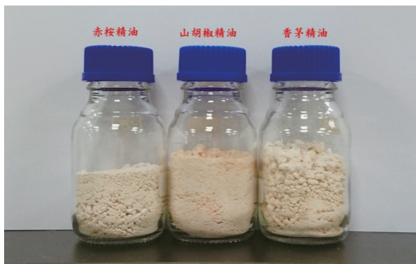
本所施作之精油微膠囊及掃描電子顯微鏡圖。
