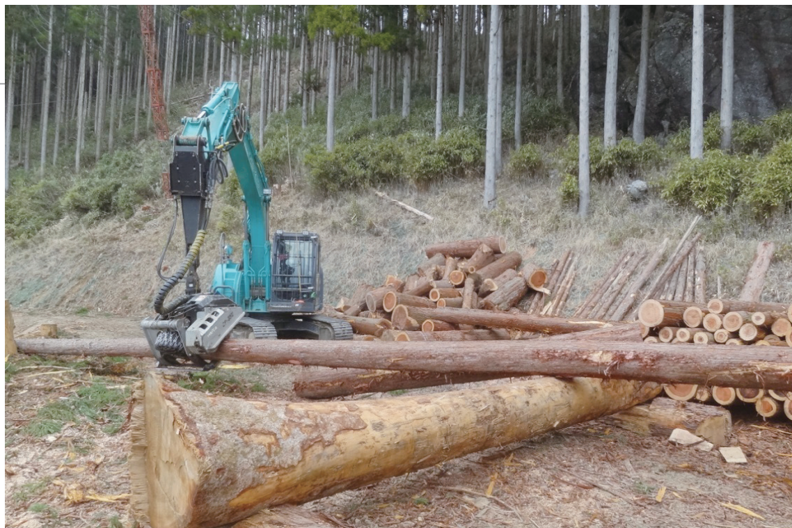
高性能造材處理機具備打枝、材積量測、鋸切造材、原木夾取整堆、整地等多功能用途。
