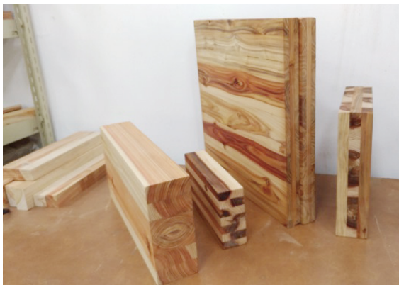
圖1 運用臺灣杉造林木製造直交積層材及集成材等結構材，由小尺寸變成大尺寸材料，再應用生產長板凳生活用座椅。
