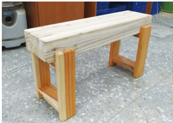
圖1 運用臺灣杉造林木製造直交積層材及集成材等結構材，由小尺寸變成大尺寸材料，再應用生產長板凳生活用座椅。
