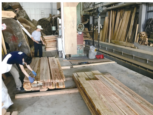
圖5 臺灣杉疏伐木切邊與切割製材。
