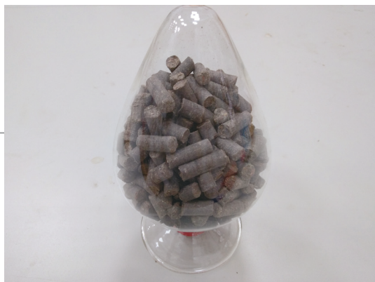
圖5 添加多孔性循環炭材之減臭木質動物墊料。(林柏亨 攝)
