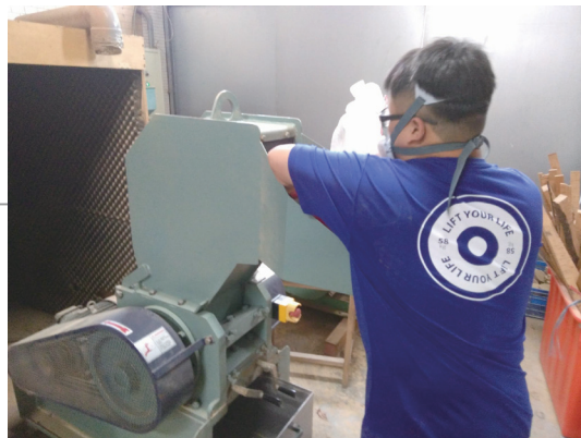
圖3 木質動物墊料製造過程。(林柏亨 攝)
