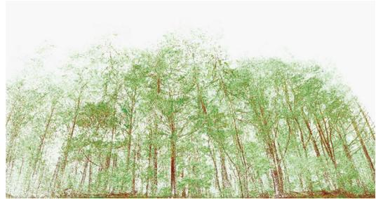
圖3 光達掃描技術具有較精確的三維測量與空間建構能力，可取得高精度的林木性態值資訊。(陳清婷 繪)
