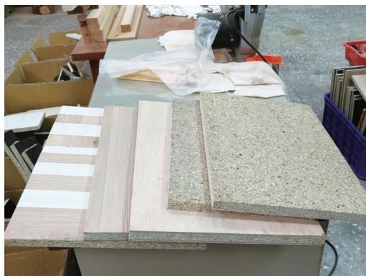
塑合板餘料再生組合板4項，由左至右依序：側拼、美耐敏板貼面、合板貼面、粒片板再製。(林振榮 攝)
