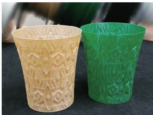
3D列印用的線材除了色料外也可以加入其他材料，賦予成品不同的面貌。(塗三賢 攝)
