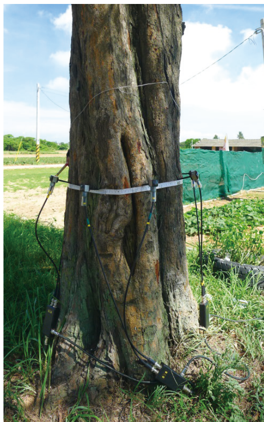
圖1 從基部開始有多處樹皮開裂與腐朽，檢測後劣化腐朽率大於50%。
