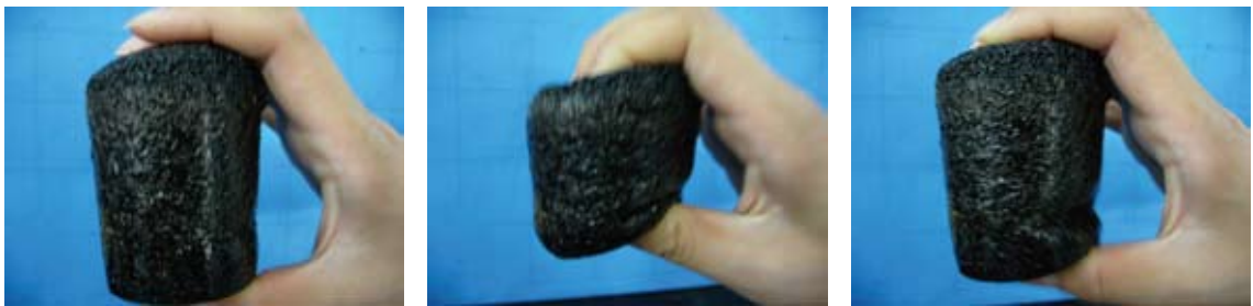
圖7. 具備回彈性PU發泡體(李文昭 製圖)
