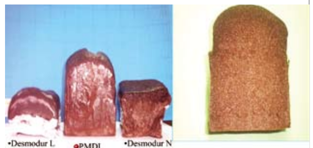
圖6. 液化木材所製作PU發泡體(李文昭 製圖)
