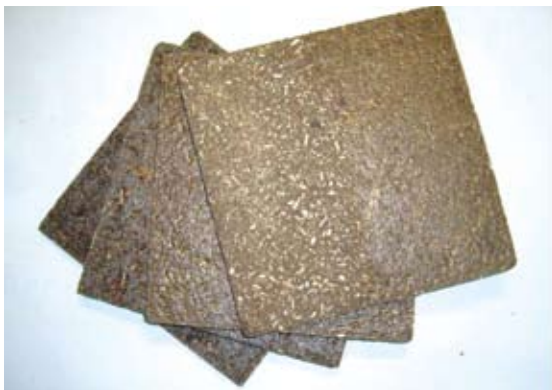
圖8. 液化木材為基質PU樹脂所製造之低密度粒片板(李文昭 製圖)
