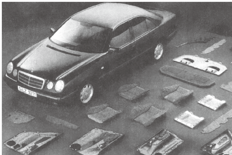
以賓士E系列房車為例，上圖顯示車內多種構件係天然纖維所製成之生物複合材料(資料來源Natural Fibers, Biopolymers, and Biocomposites, Chapter 7, p248)
