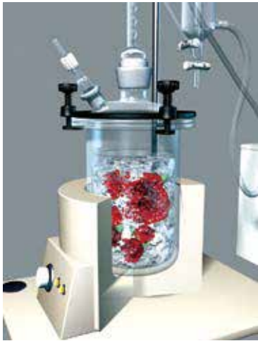
圖2. 雙重冷卻泛用型精油萃取裝置(水中蒸餾)示意圖(尹華文 製圖)
