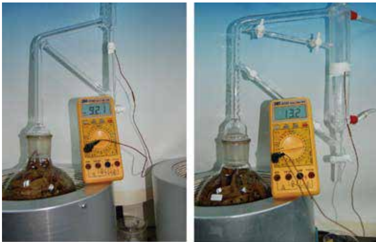
圖6. 傳統水蒸氣蒸餾與新型雙重冷卻蒸餾於精油集油管外側溫度之差異(傳統蒸餾 92.1°C；新型雙重冷卻蒸餾13.2°C)(尹華文 攝)
