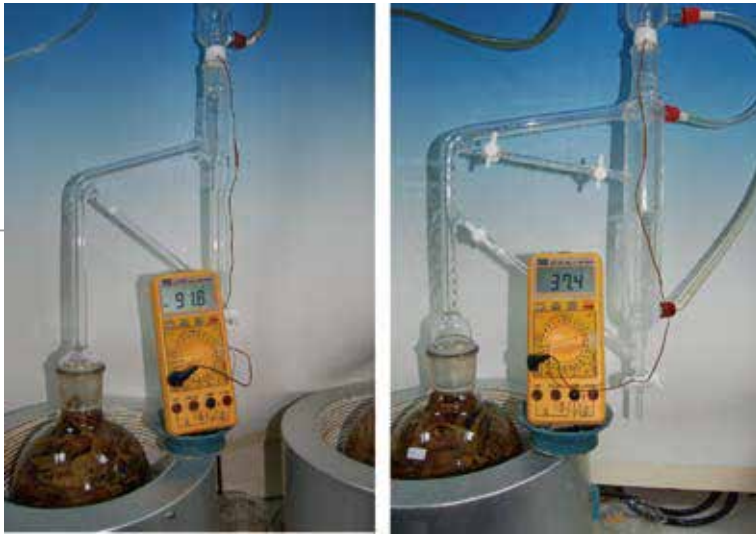
圖5. 傳統水蒸氣蒸餾與新型雙重冷卻蒸餾於冷凝管下方溫度之差異(傳統蒸餾 91.8°C；新型雙重冷卻蒸餾37.4°C)(尹華文 攝)
