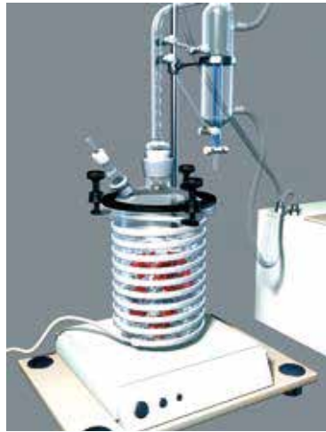
圖3. 加熱裝置使用電熱爐及電熱帶之示意圖(尹華文 製圖)
