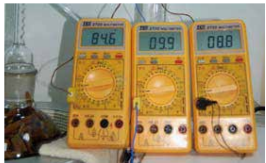
圖7. 新型雙重冷卻蒸餾精油收集管各部位之溫度(蒸餾作業時，油水蒸氣進入精油收集管內，被冷卻循環水(8.8°C)冷卻後，瞬間由氣態變成液態(84.6°C)，此刻，水及精油在冷卻循環水(8.8°C)冷卻下，精油收集管內也由84.6°C遽降為9.9°C。)證實雙重冷卻效果極佳，蒸餾期間常保低溫，因此，精油質優且收率高(尹華文 攝)
