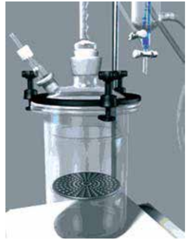
圖4. 分離式雙口直筒式蒸餾槽可依材料選擇進行水中蒸餾，或加置不銹鋼隔板進行水上蒸餾，並可注水及快速裝卸(尹華文 製圖)
